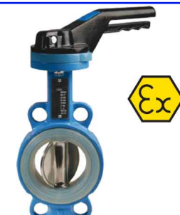
fig 215S FP wafer type PN10/16 ansi 150 lbs huis nodulair gietijzer + epoxy coating vlinder RVS316 gepolijst / as RVS316 dichting voedingsgeschikte SILICONE DN32 - DN300 temp. : -30°C/+150°C voorzien van iso 5211 topflens wormwielkast op aanvraag verwisselbare dichting
