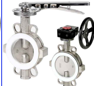
fig 230 wafer type PN10/16 ansi 150 lbs huis RVS316 vlinder en as RVS316 dichting PTFE op EPDM basising DN50 - DN250 temp. : -25°C/+180°C voorzien van iso 5211 topflens wormwielkast vanaf DN150 inbouw lengte volgens DIN 3202 K1
