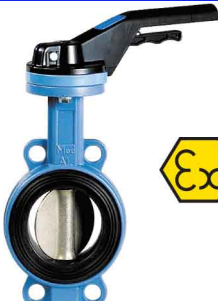
fig 215B wafer type PN10/16 ansi 150 lbs huis nodulair gietijzer + epoxy coating vlinder en as RVS316 dichting NBR DN32 - DN500 temp. : -20°C/+90°C voorzien van iso 5211 topflens wormwielkast op aanvraag verwisselbare dichting
