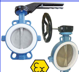
fig 215PTFE wafertype PN10/16 ansi 150lbs huis nodulair gietijzer + epoxy coating vlinder en as RVS316 dichting PTFE op silicone liner DN32 - DN300 temp. : -25°C/+200°C voorzien van iso 5211 topflens wormwielkast op aanvraag verwisselbare dichting
