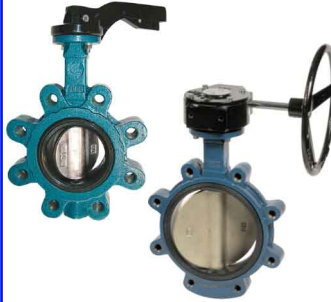
fig 250 lug type PN10/16 huis gietijzer + epoxy coating vlinder nodulair gietijzer vernikkeld dichting EPDM DN40 - DN600 temp. : -20°C/+120°C voorzien van iso 5211 topflens fig 250R : met wormwielkast ge vulcaniseerde dichting
