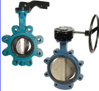
fig 260 lug type PN10/16 huis gietijzer + epoxy coating vlinder en as RVS316 dichting EPDM DN40 - DN600 temp. : -20°C/+120°C voorzien van iso 5211 topflens fig 260R : met wormwielkast ge vulcaniseerde dichting
