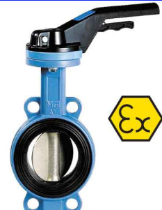
fig 214 wafer type PN10/16 ansi 150 lbs huis nodulair gietijzer + epoxy coating vlinder ALU-BRONS / as RVS316 dichting NBR DN32 - DN500 temp. : -20°C/+90°C voorzien van iso 5211 topflens wormwielkast op aanvraag verwisselbare dichting
