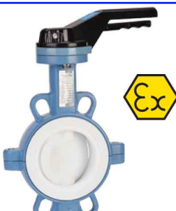
fig 215TT wafer type PN10/16 ansi 150 lbs huis nodulair gietijzer + epoxy coating vlinder RVS316 + TEFLON / as RVS316 dichting PTFE op silicone liner DN32 - DN300 temp. : -25°C/+200°C voorzien van iso 5211 topflens wormwielkast op aanvraag verwisselbare dichting
