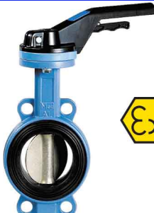
fig 215 wafer type PN10/16 ansi 150 lbs huis nodulair gietijzer + epoxy coating vlinder en as RVS316 dichting EPDM DN32 - DN600 temp. : -20°C/+120°C voorzien van iso 5211 topflens wormwielkast op aanvraag verwisselbare dichting
