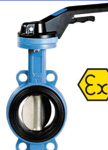
fig 215V wafer type PN10/16 ansi 150 lbs huis nodulair gietijzer + epoxy coating vlinder en as RVS316 dichting VITON DN32 - DN500 temp. : -10°C/+180°C voorzien van iso 5211 topflens wormwielkast op aanvraag verwisselbare dichting
