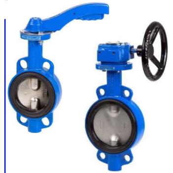
fig 2100 wafer type PN10/16 ansi 150 lbs huis gietijzer + epoxy coating vlinder nodulair gietijzer vernikkeld dichting EPDM DN50 - DN500 temp. : -20°C/+120°C voorzien van iso 5211 topflens wormwielkast vanaf DN300
