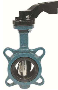
fig 210BT wafer type PN10/16 ansi 150 lbs huis gietijzer + epoxy coating vlinder en as RVS316 dichting NBR DN32 - DN300 temp. : -20°C/+80°C voorzien van iso 5211 topflens ge vulcaniseerde dichting
